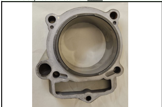
C3-15 Sylindrblokk sett fra bunn Bare cylinder block seen from bottom
