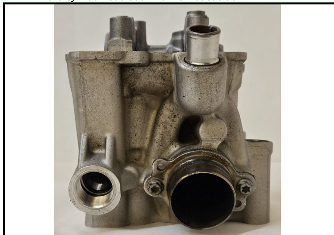
C8-4) Topplukk sett fra eksossiden Bare cylinderhead seen from exhaust side
