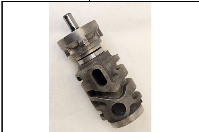
F9-10) Assemblage du barillet Selector barrel assembly
