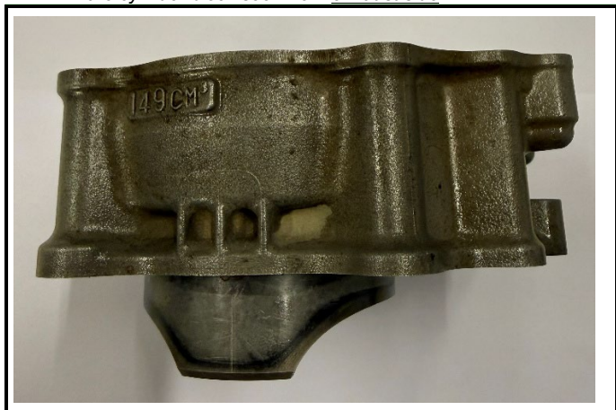
C3-15 Sylindereblokk sett fra eksosiden Bare cylinder block seen from exhaust side
