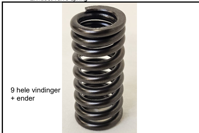
C10-9) Ventilfjær eksos Exhaust valve spring
