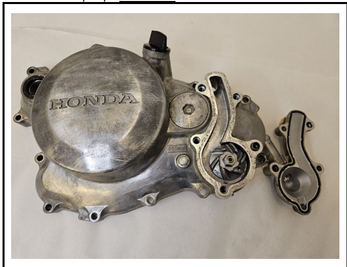
C13-5) Turbinhjulet på vannpumpe Turbine wheel of water pump
