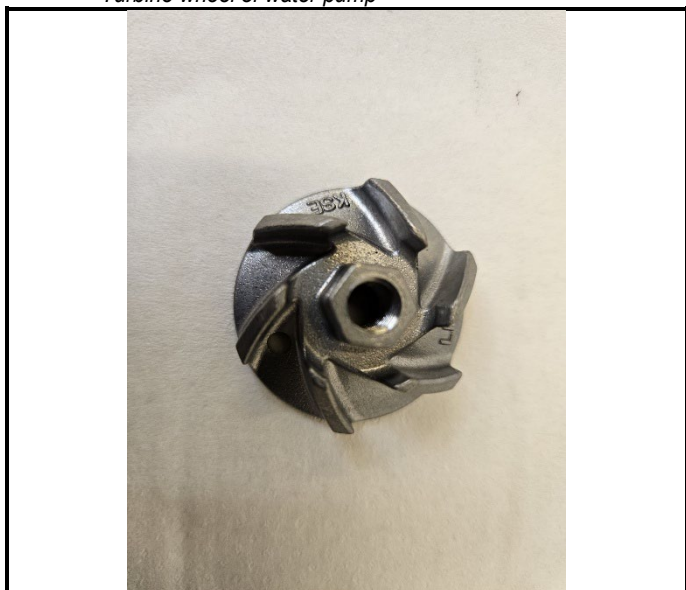
C13-5) Turbinhjulet på vannpumpe Turbine wheel of water pump
