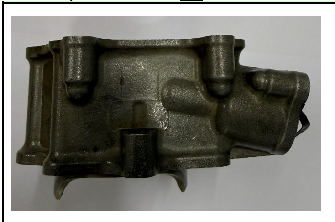
C3-15 Sylindereblokk sett fra eksosiden Bare cylinder block seen from exhaust side
