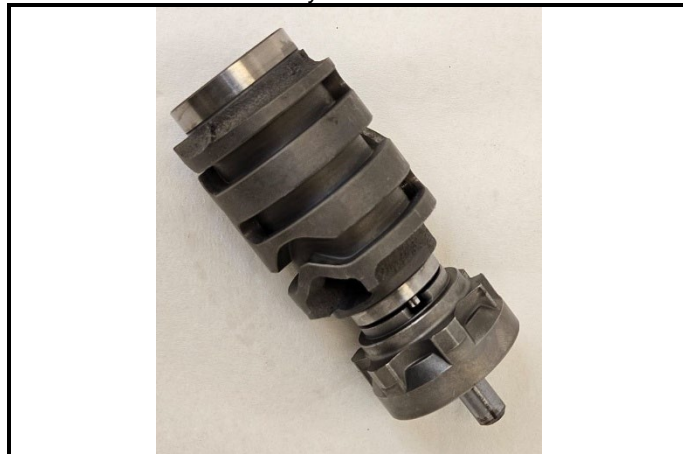
F9-11) Assemblage du barillet Selector barrel assembly
