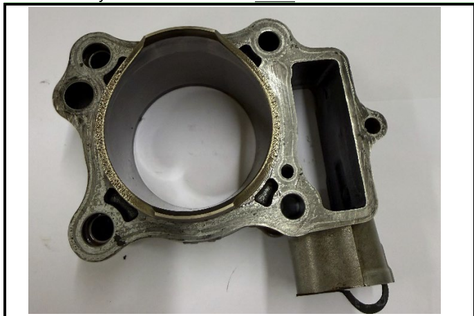
C3-13 Sylindereblokk sett fra siden Bare cylinder block seen from side
